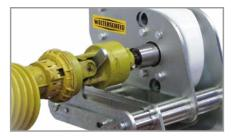
Kupplungsaufnahme Flexible Kupplungsaufnahme durch Wechselzapfen und Gegenhalter
