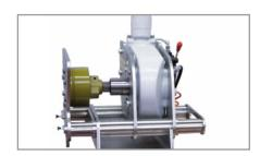
**Der Drehmomentprüfstand SW42**Kabellose Datenerfassung mittels Bluetooth und rechnergestützte Auswertung
