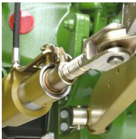
Le stabilisateur latéral à commande hydraulique HGST
