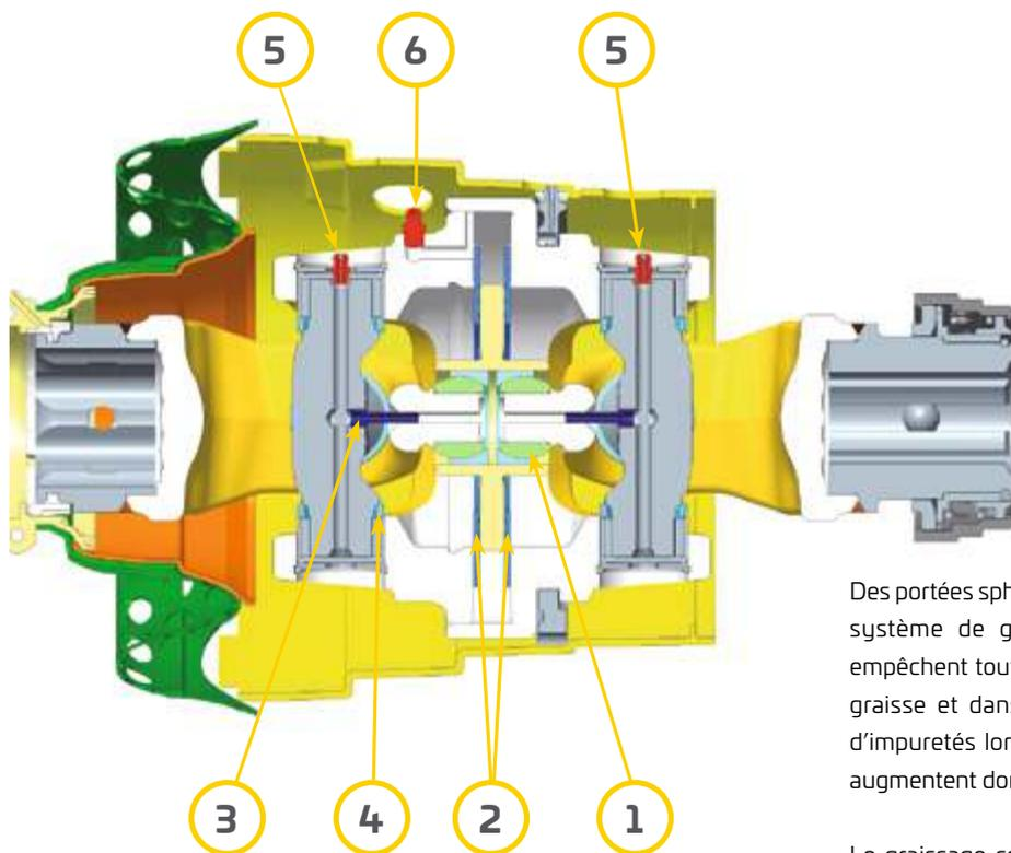
Des portées sphériques (1) haut-de-gamme réduisent l'usure du système de guidage. Des disques flottants alvéolés (2) empêchent toute ouverture par laquelle pourrait s'échapper la graisse et dans laquelle pourraient pénétrer des particules d'impuretés lors de la mise en position angulaire du joint. Ils augmentent donc la durée de vie du système de guidage.
