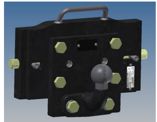
Bild 2: ANP50-4/1-2 mit KuP 309-4 und Kugel 50 mit Halterung Typ 329076
