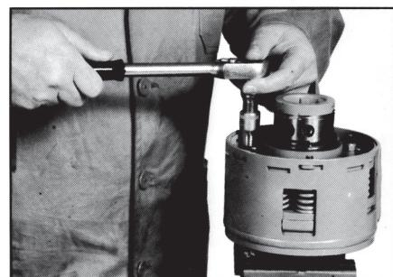
1. Einstellring durch Anziehen der 6 Muttern am Federpaket entlasten.
