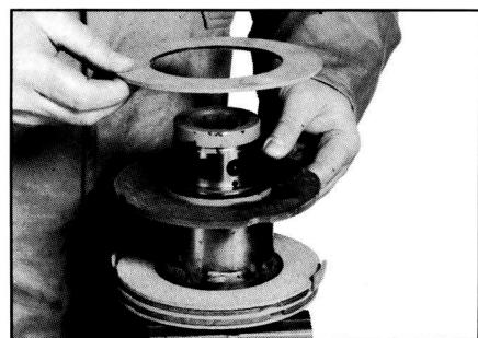
1. Reibscheiben und Mitnahmescheiben in richtiger Reihenfolge auf Flanschnabe montieren.
