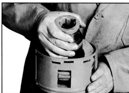
2. Flanschnabe mit Reib- und Mitnahmescheiben in Kupplungsgehäuse einsetzen
