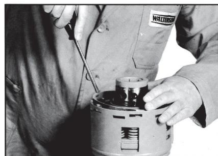
2. Montageposition des Einstellringes zum Gehäuse markieren. Dann Einstellring entfernen
