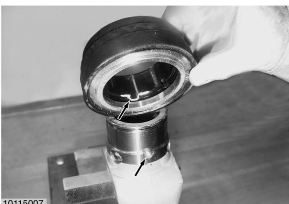
QS-Schnellverschluss so aufschieben, dass die Sperrnase in Aussparung am Gabelschaft einrastet. (Pfeile)
