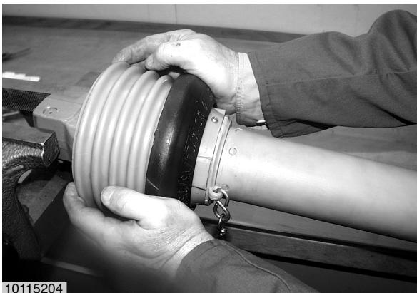
Stützring nachdrücken, bis er auf dem gesamten Umfang auf der ersten Rippe des Trichters eingerastet ist.
