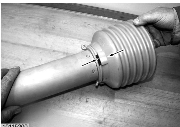
Schutztrichter in Montageposition drehen (Pfeile).
