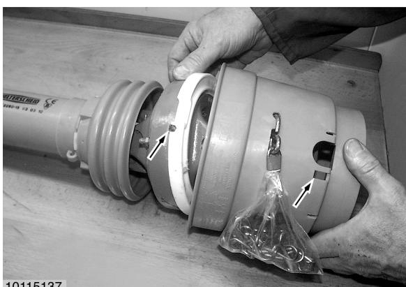
Doppelgabel-Schutztrichter von Anschlussseite aufschieben und über Nocken positionieren, so dass Schraubenlöcher in Aussparungen sichtbar sind.
