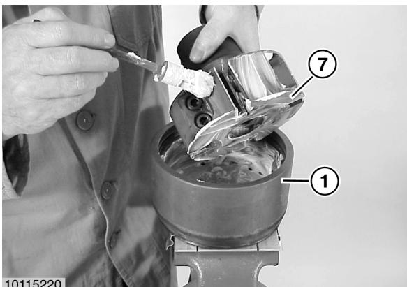
Vormontierte Nabe (7) an den Stirnflächen, am Außenumfang, in den Keilnuten fetten und ins Gehäuse (1) einsetzen.
