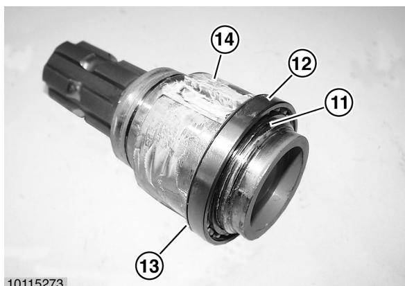
Sicherungsring (11) von der Nabe (14) abnehmen. Rillenkugellager (12) abdrücken und Scheibe (13) abnehmen.
