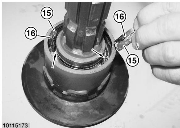
Blattfedern (16) und Sperrkeile (15) in die Aufnahmen (Pfeile) einsetzen.
