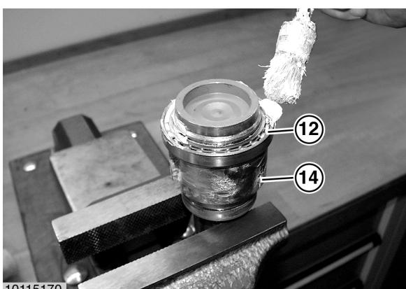
Rillenkugellager (12) bis zur Anlage auf die Nabe (14) pressen.
