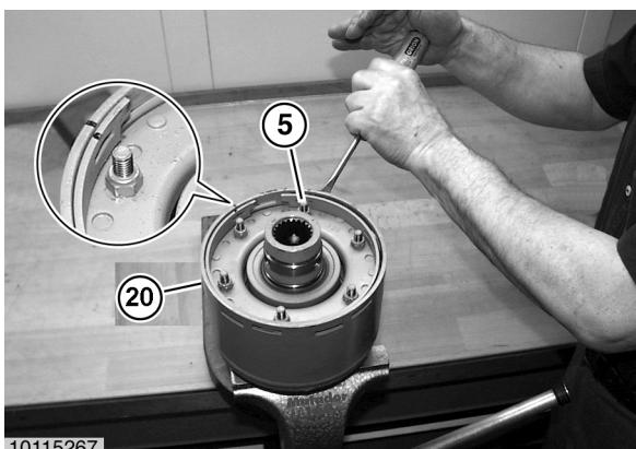
Montageposition des Einstellrings (5) zum Gehäuse (20) markieren.
