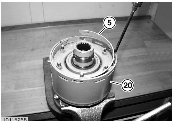
Einstellring (5) vorsichtig aus dem Kupplungsgehäuse (20) heraushebeln.
