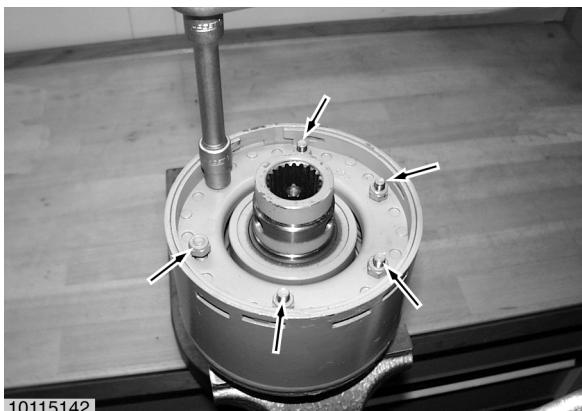
Einstellring, durch abwechselndes Anziehen (eine Umdrehung) der sechs Muttern (Pfeile) am Federpaket entlasten.
