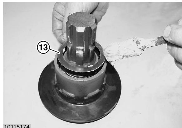
Sicherungsring (11) montieren.
