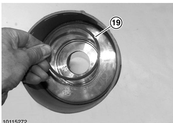
Bei Bedarf Laufring (19) aus dem Kupplungsgehäuse drücken und wechseln.
