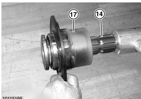
Nabe (14) aus dem Mitnehmer (17) treiben. Sperrkeile und Blattfedern prüfen, defekte Teile wechseln.
