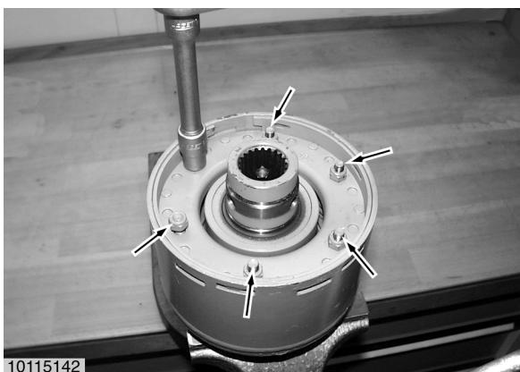
Die sechs Muttern (Pfeile) am Federpaket abwechselnd (jeweils eine Umdrehung) bis Gewindeauslauf zurückdrehen. Die Kupplung ist nun einsatzbereit.
