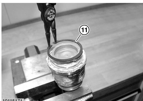
Sicherungsring (11) montieren.
