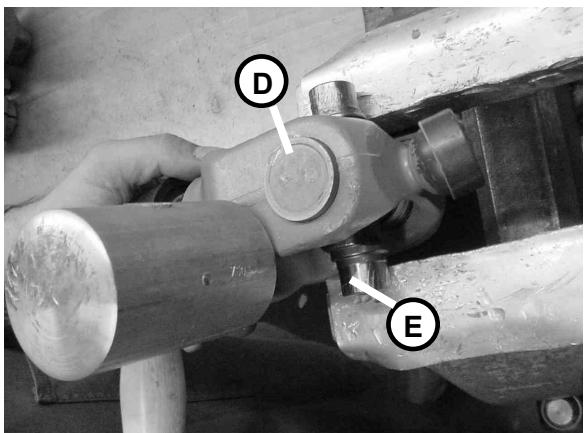
Kreuzzapfen (E) wie gezeigt auf Schutzbacken aufliegen und Lagerbüchse (D) durch leichte Hammerschläge hochtreiben. Lagerbüchse wie beim Gelenk ausziehen.
