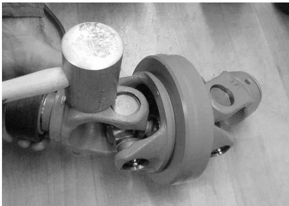
Gelenk durch Hammerschläge auf die Gabelschenkel entspannen.
