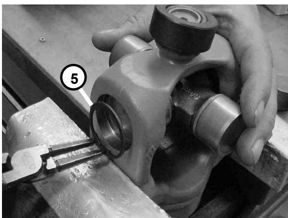
Sicherungsring (5) montieren.
