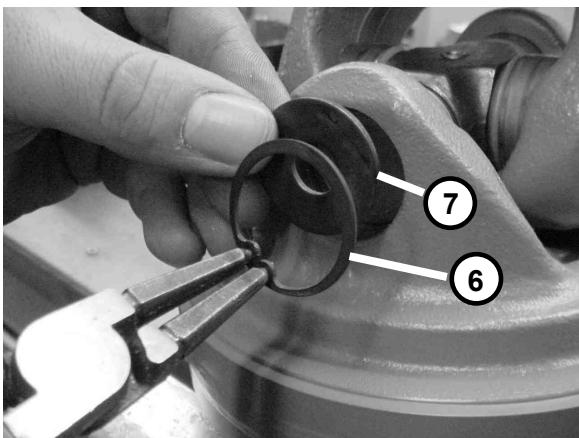
Sicherungsring (6) montieren.
