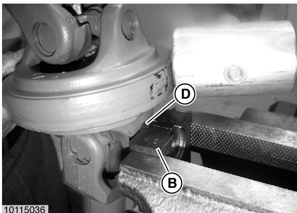
Gabel mit Lagerbüchse (D) in Sonderwerkzeug SW23/SW27 (B) bzw. (C) einspannen. Durch leichte Schläge gegen Flansch bzw. durch Drehbewegungen Lagerbüchse herausnehmen. Die anderen Lagerbüchsen in gleicher Weise ausbauen.
