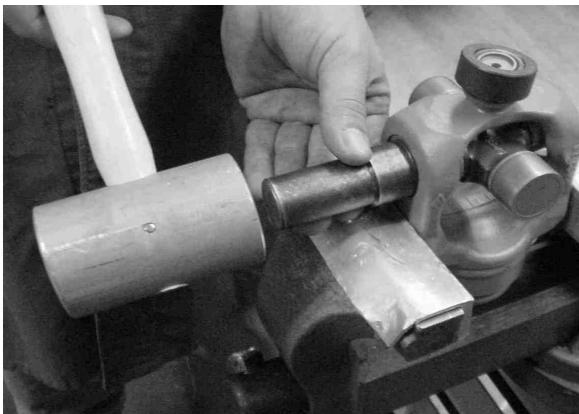
Lagerbüchse mit Austreiber SW28 soweit einschlagen, bis Ring-nut sichtbar.
