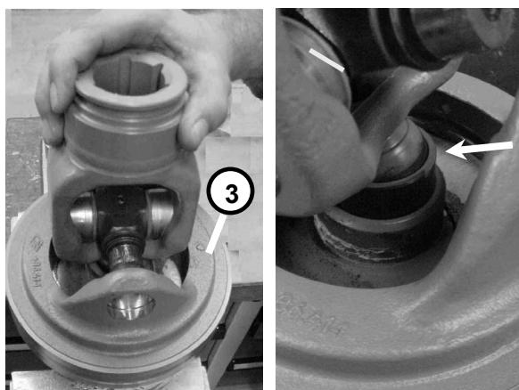
Führungsteile (Gelenklager und Nabenhals) (Pfeil) mit agraset 116 fetten. Gelenklager in Führungsnahe und Kreuzzapfen in Doppelgabel (3) einsetzen.
