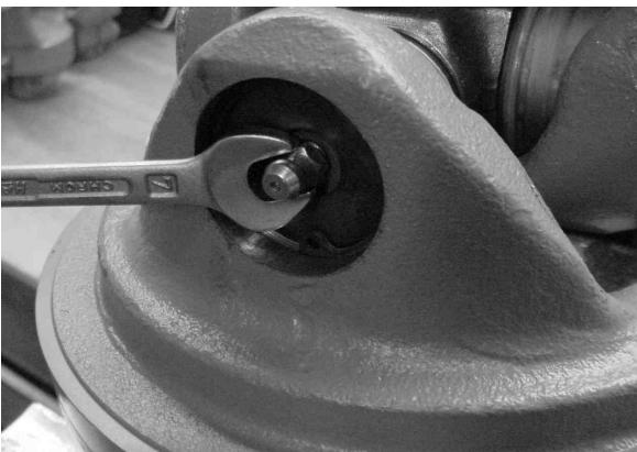
Schmiernippel in die Büchse eindrehen und festschrauben.
